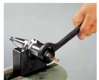
Festziehen der Mutter (Schraubstöcke können festgeklemmt werden)
