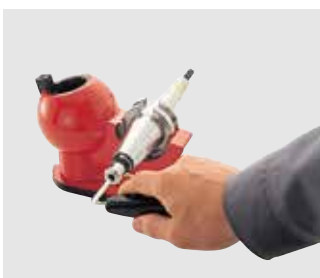
Festklemmen der Slimline-Spannzange
